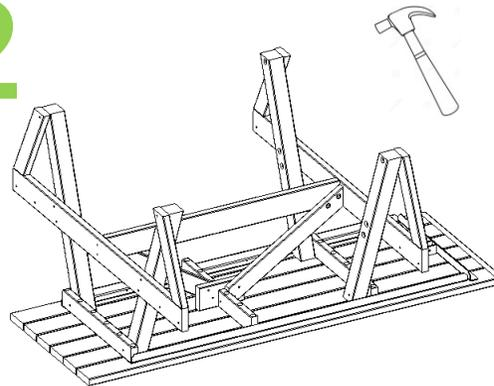
1º - COLOCAR OS PARAFUSOS, NOS FUROS DOS PÉS ENCAIXAR COM OS FUROS DAS RÉGUAS TAMPO.
