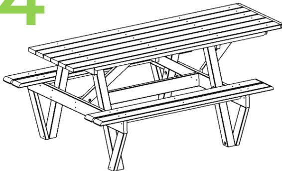
1º - VIRAR A MESA COM O TAMPO PARA CIMA. COLOCAR AS TABUAS DO ACENTO E ALINHAR COM OS FUROS DOS PÉS. 2º - APÓS TER ENCAIXADO TODOS OS PARAFUSOS, DAR UMA LEVE BATIDA COM UM MARTELO NA CABEÇA DO PARAFUSO E COM A CHAVE DE APERTO (FORNECIDA NO KIT) APERTAR TODAS AS PORCAS.
