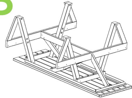
1º - POSICIONAR A MÃO FRANCESA NA PONTA DO TAMPO, CONFORME FIGURA. 2º - APÓS TER ENCAIXADO OS DOIS PARAFUSOS, COM A CHAVE DE APERTO (FORNECIDA NO KIT) APERTAR TODAS AS PORCAS.
